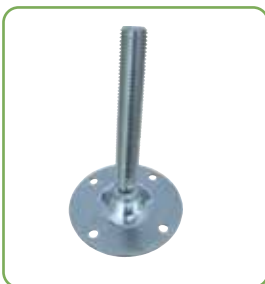
Part. R0349 - Pag. R34 Ø 123 • N. 4 fori • Acciaio inox e zincato • Carico max. 10000 N.
