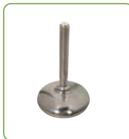
Part. R0747 - Pag. R36 Ø 80 • Acciaio inox • Sanificabile • Carico max. 25000 N.
