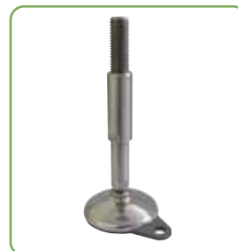
Part. R0750SF - Pag. R38 Ø 80 • Acciaio inox • Sanificabile • Predisposto al fissaggio • Carico max. 25000 N.
