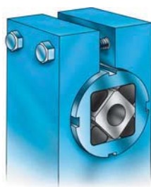
Fig. 3 Quadro fissato a morsetto
