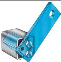
Fig. 17 Fissaggio mediante bulloni
