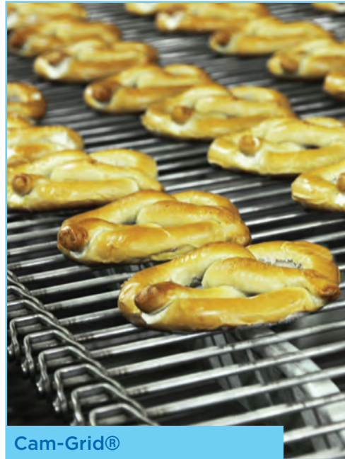
Cam-Grid® Nastro a griglia con gabbia a spirale standard di Cambridge (mostrato solo come barra; disponibile con copertura in rete)
