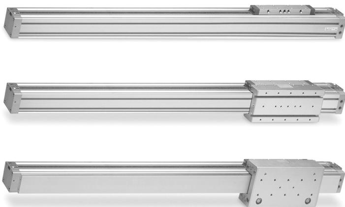
I cilindri senza stelo Serie 52 sono disponibili in 5 alesaggi (25, 32, 40, 50 e 63 mm) e in tre versioni: standard (M), guidata a strisciamento (G) e guidata a rulli (R). Tutte e tre le versioni sono disponibili con carrello standard o carrello corto per coprire una gamma più ampia di applicazioni. La Serie 52 è inoltre disponibile nella versione con alimentazione dell'aria da un solo lato.
