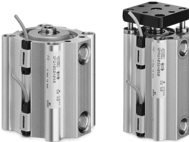
I cilindri a corsa breve Serie QP - QPR magnetici sono stati realizzati in dieci diversi alesaggi dal Ø 12 al Ø 100. La loro compattezza ne consente l'installazione in piccoli spazi. Le particolari soluzioni costruttive permettono l'impiego di questi cilindri anche con fissaggi a piedini e a cerniera.
