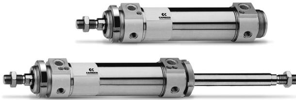
I cilindri Serie 42 sono stati realizzati senza tiranti in modo da rendere più pulito il loro design. Tubo e stelo sono realizzati in acciaio INOX, mentre le testate sono in Alluminio anodizzato.
