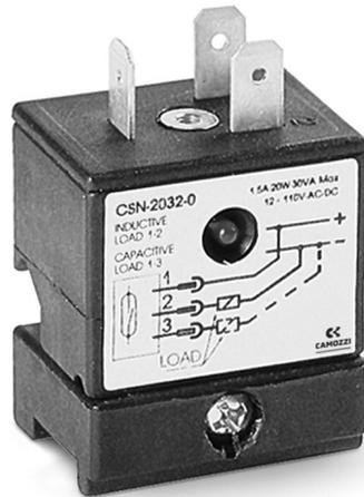
Il sensore di prossimità elettrico Mod. CSN 2032-0 è costituito da un'Ampolla Reed completa di circuito elettronico di protezione e da un segnalatore visivo di contatto costituito da un led rosso, la resina presente all'interno dell'involucro garantisce un'elevata protezione ed isolamento.
