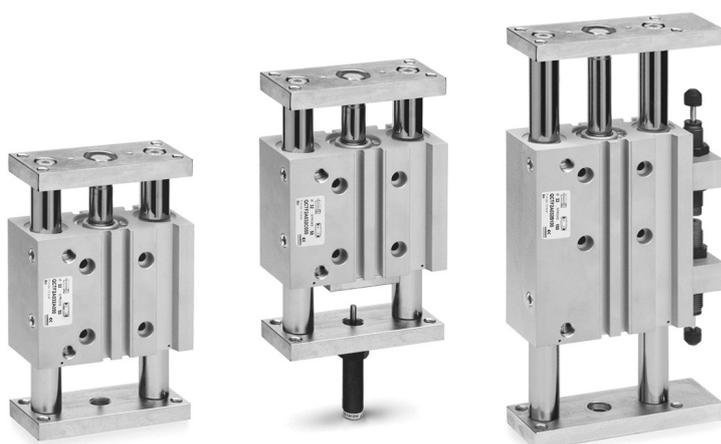
Le Serie QCTF-QCBF sono state realizzate per applicazioni in cui lo spazio è ridotto. Gli attuatori sono disponibili in 2 versioni: una dotata di doppia guida a bronzine (Mod. QCTF) e la seconda con manicotti a sfere (Mod. QCBF). La versione QCTF è consigliata in presenza di carichi laterali elevati, la versione QCBF è adatta per cicli veloci con minor carico laterale e grande precisione.
