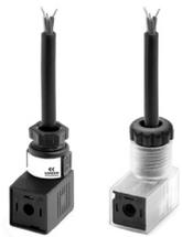
Il circuito raddrizzatore interno del connettore Mod. 125-900 permette l'utilizzo delle elettrovalvole con corrente alternata nelle varie tensioni, anche quando i dati di targa della elettrovalvola sono in corrente continua.
