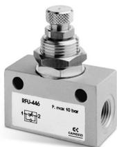
Poichè la velocità di un cilindro si regola intercettando l'aria della camera che sta scaricando, si consiglia di collegare la bocca filettata della valvola 1 con l'entrata del cilindro e la 2 con l'utilizzo della valvola.
