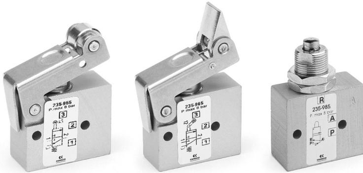
Le valvole miniaturizzate con comando meccanico a 3/2 vie NC Serie 2 sono disponibili con attacchi filettati M5 oppure con raccordo super rapido per tubi Ø4. I dispositivi sono ad azionamento frontale, a leva rullo unidirezionale.
