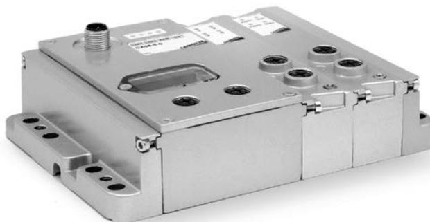
Il modulo seriale Serie CX, con grado di protezione IP65, può gestire i protocolli di comunicazione seriali tradizionali e quelli di nuova generazione come EtherCAT, EtherNet/IP e PROFINET. L'elevata resistenza meccanica della struttura in alluminio lo rende adatto per montaggi anche in applicazioni gravose. Abbinabile con moduli elettrici di ingresso e uscita, può gestire fino ad un massimo di 1024 I/O. Tramite dei moduli d'interfaccia
