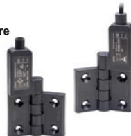
Interruttore di sicurezza con un contatto normalmente chiuso (NC) e un contatto normalmente aperto (NO) in scambio. Apertura positiva a norma IEC EN 60947-5-1. Doppio isolamento dei circuiti interni. Omologazione UL:E360222. Dimensione: 53 mm
