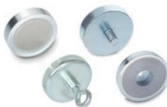
Corpo di contenimento in acciaio zincato (RMA, RMB, RMC), acciaio laccato (RME), tecnopolimero (RMT) o acciaio INOX (RMC). Foro passante, perno o inserto filettato. Magnete in ferrite, samario cobalto (SmCo), neodimio ferro boro (NdFeB) o alluminio nickel cobalto (AlNiCo), schermato a prestazioni elevate.  $\varnothing D = 6 \div 125$   $L = 4.5 \div 26$
