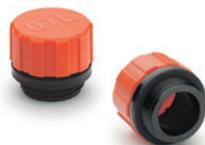
Coperchio in tecnopolimero arancio; raccordo filettato in tecnopolimero nero o attacco rapido a baionetta in acciaio zincato. Con o senza filtro d'aria in schiuma poliuretanic "tech-foam". Rondella piana in gomma NBR. Temperatura massima in continuo: 100° C. Diametri: 30 - 40 - 57 - 70 mm
