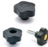
Boccola in acciaio brunito con foro cieco liscio; boccola ottone con foro filettato cieco o passante; prigioniero filettato in acciaio zincato. Calottina in sei colori. Disponibili anche in tecnopolimero certificato autoestinguente UL-94 V0 (VCT.AE-V0). Diametri: 25 - 32 - 40 - 50 - 63 - 74 - 95 mm
