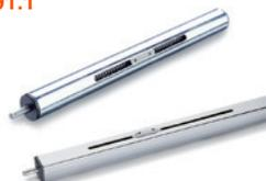
Vite senza fine con filettatura trapezoidale in acciaio INOX AISI 303; cursore in ottone. Esecuzioni standard: vite con filettatura a destra o sinistra, sporgente su un lato o su entrambi i lati. Corsa: 65 - 70 - 100 - 115 - 150 - 165 - 170 - 200 - 215 - 220 - 265 - 270 - 300 - 315 - 320 - 720 mm
