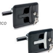
Maniglia colore nero o grigio. Esecuzioni standard: serratura a cifratura differenziata o a cifratura unica. Due chiavi in ottone nichelato estraibili in due posizioni a 90°. Montaggio a mezzo 4 viti in acciaio zincato costampate nella base. Il ribaltamento della maniglia nell'apposita sede trasla assialmente l'albero con la leva in direzione del battente fino alla posizione di blocco. Dimensione: 128 mm, campo di regolazione da 13 a 75 mm
