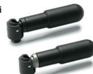
Perno in acciaio brunito o in acciaio INOX AISI 303, supporto in tecnopolimero. Il dispositivo di richiamo "Fold-O-matic" provvede automaticamente a riportare l'impugnatura in posizione ripiegata.
