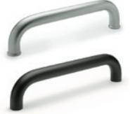
Barra o tubo in alluminio con rivestimento in resina epossidica, colore nero. GN 426.1 a doppia curva o GN 426.5 in acciaio INOX AISI 304. Fori ciechi filettati nella barra per Ø 20 mm o bocche filettate in alluminio o in acciaio INOX AISI 303 riportate nel tubo per Ø ≥ 28 mm.
