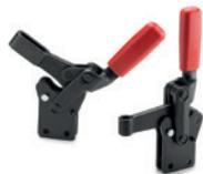
Perni di rotazione e bussole di supporto in acciaio temprato, brunito e rettificato; vite e dado di regolazione in acciaio zincato; impugnatura in poliuretano rosso. Con leva di serraggio aperta e due rondelle piegate o leva di serraggio piena.
