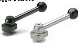
Impugnatura in Duroplasto. Vite in acciaio nitrurato e brunito o temprato e nichelato. Camma eccentrica o elicoidale "a tirare" o "a premere", in acciaio cementato e brunito o acciaio INOX AISI 303 nichelato (GN 918.5). Il sistema è autobloccante a qualsiasi posizionamento angolare. Diametro camma: 50 mm
