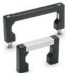
Supporti laterali in tecnopolimero e tubo in alluminio, colore naturale o nero. Montaggio posteriore, boccole filettate in acciaio zincato; montaggio frontale, fori passanti per viti a testa cilindrica in acciaio INOX e dadi autobloccanti zincati. Adatte all'impiego su rack 19". Interassi di fissaggio: 55 - 88 - 100 - 120 - 180 mm
