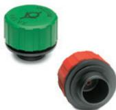
Colore rosso con guarnizione a membrana in gomma sintetica EPDM, colore verde con guarnizione a membrana in gomma sintetica FKM. Raccordo filettato colore nero. Rondella piana in EPDM (coperchio rosso) o FKM (coperchio verde). Temperatura massima di esercizio in continuo: 50° C. Filettatura GAS: 1 1/4
