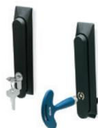
Perno maniglia in lega di zinco cromata con OR in gomma sintetica NBR; guarnizioni di tenuta in silicone e gomma NBR; viti in acciaio zincato. Esecuzioni standard: serratura con cifratura differenziata, con cifratura unica o per chiave in tecnopolimero con inserto in zama e innesto a due alette, statore di tipo europeo, esecuzione con grado di protezione IP 65. Dimensione: 160 mm
