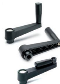
Boccola acciaio brunito, foro quadro passante H9; mozzo acciaio brunito con foro cieco H9 o passante alesato H7.
