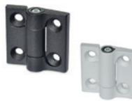
Elementi frizionanti conici in tecnopolimero, vite e dado in acciaio zincato. Montaggio mediante fori passanti per viti a testa svasata piana. Angolo di rotazione: max 270° (-90° e +180° con 0° = complanarità delle superfici interconnesse). Coppia resistente max: 2 - 4 - 6.5 Nm. Dimensioni: 40 - 50 - 60 mm
