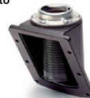
Piastra in tecnopolimero con guarnizione di tenuta in gomma sintetica NBR; flangia in acciaio zincato con attacco rapido a baionetta o in tecnopolimero con attacco filettato (PLRF+C) e rondella piana in sughero impregnato, gomma MGS; cestello filtrante in tecnopolimero. Filettatura GAS per serie PLRF+C: 1 1/4
