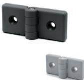
Uno o due (CFI) perni di rotazione in acciaio nichelato. Tasselli di centraggio in tecnopolimero per profilati di alluminio da 6 a 12 mm. Montaggio mediante fori passanti. Angolo di rotazione: CFG. max 280° (-100° e +180°). CFI. max 260°/275° (-95° e +165°/180°) con 0° = complanarità delle superfici interconnesse. Dimensione: 36 mm
