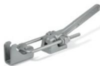
Perno in acciaio temprato e rettificato; tirante doppio, perno oscillante e dadi in acciaio naturale. Con foro per serraggio a mezzo tubo rimovibile o con leva di serraggio.
