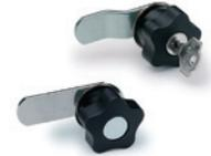
Statore e rotore in zamà; ghiera in ottone; rosetta elastica, rondella di posizionamento e levetta di chiusura in acciaio zincato; due chiavi in ottone nichelato, estraibili in due posizioni a 180° (serratura aperta o chiusa). Esecuzioni standard: apertura a destra o a sinistra; serratura con cifratura differenziata, unica, differenziata e passe-partout o senza serratura. Diametro volantino: 40 mm
