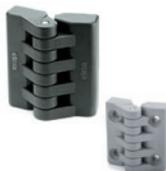
Perno di rotazione in acciaio INOX AISI 303 o tecnopolimero (CFAX). Montaggio mediante boccole ottone nichelato, foro filettato; prigionieri filettati in acciaio nichelato; fori e asole (CFA-SL) passanti per viti a testa cilindrica. Angolo di rotazione max 215° (-35° e +180° con 0° = complanarità delle superfici). Dimensioni: 40 - 49 - 65 - 97 mm
