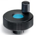
Calottina in sei diversi colori. Boccola in ottone, foro cieco liscio, fissaggio per mezzo di una vite di pressione trasversale. Diametri: 40 - 50 - 60 - 70 - 85 - 100 mm
