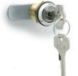
Statore e rotore in lega di zinco, ghiera in ottone, levetta, rondella e rosetta in acciaio zincato. Due chiavi in ottone nichelato estraibili in due posizioni a 180°. Esecuzioni standard: serratura a cifratura differenziata o a cifratura unica. Dimensioni: da 13 a 30 mm
