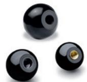
Foro cieco filettato; boccola in ottone con foro cieco filettato; foro cieco liscio leggermente conico, montaggio a pressione mediante accoppiamento elastico. Diametri: 12 - 16 - 20 - 25 - 30 - 32 - 35 - 40 - 45 - 50 mm
