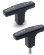
Elemento di serraggio in tecnopolimero, boccola ottone con foro cieco filettato oppure prigioniero filettato in acciaio zincato. In caso di urti accidentali, la maniglia ruota liberamente senza compromettere il serraggio. L.652-X maniglie a ripresa con innesto "tirando". Grandezze: 67 - 80 mm
