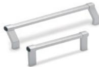
Supporti laterali in alluminio, disponibili inclinati o dritti; fori ciechi filettati per viti M5. Barra in alluminio, superficie rettificata. Tappi di chiusura laterali in tecnopolimero. Adatte all'impiego su rack 19" e strumentazione in genere. Interassi di fissaggio: 88 - 100 - 120 - 200 mm
