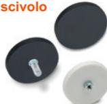
Inserto filettato in acciaio zincato con foro passante, perno filettato, gambo, impugnatura o anello. Magnete in neodimio ferro boro (NdFeB). La superficie in elastomero aumenta il coefficiente di attrito. Indicati per impieghi su superfici sensibili.  $\varnothing D = 12 \div 88$   $L = 6 \div 8.5$
