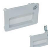
Maniglia colore nero o grigio. Esecuzioni standard: innesto chiave triangolare, quadro 7x7 o a due alette, posizionato a destra o sinistra. Montaggio a mezzo 5 viti in acciaio zincato. Levetta di chiusura GN 115 in acciaio zincato. Dimensione: 128 mm, campo di regolazione da 13 a 75 mm
