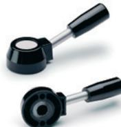
Corpo centrale in tecnopolimero; braccio in acciaio cromato, impugnatura cilindrica in Duroplasto; mostrina frontale autoadesiva in alluminio anodizzato. Foro liscio conformato con faccia piana o boccola in acciaio brunito, foro alesato H7. Grandezze: 81 - 108 - 127 - 170 mm
