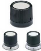
Calottina copriboccola in tecnopolimero; flangia in alluminio anodizzato opaco con indice triangolare o graduazione di precisione in colore nero, incisi a laser. Boccola acciaio brunito, foro alesato H7. Fissaggio con linguetta o spina elastica trasversale oppure per mezzo di viti a pressione. Diametri: 32 - 37 - 42 - 48 - 52 - 58 - 63 - 80 mm
