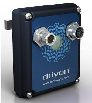
Questo modulo opzionale realizza l'interfaccia hardware e software per reti Ethernet-Real-Time con profilo Ethercat. Sulla facciata esterna del modulo sono presenti due connettori M12 D-code (maschio e femmina) per una connessione di tipo Line alla rete di campo.
