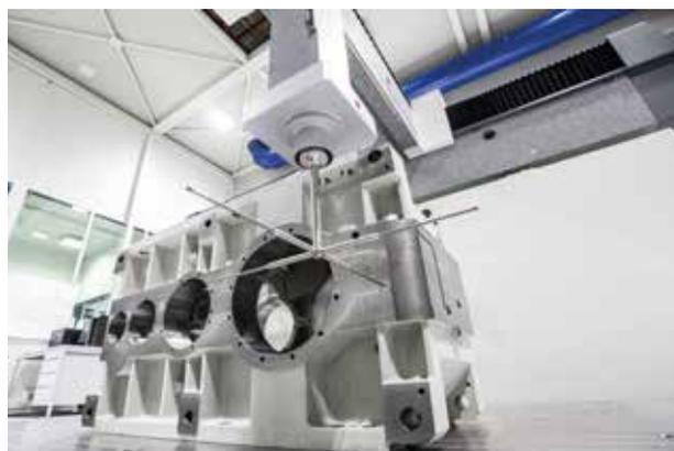
Carcassa in due metà in ghisa sferoidale (UNI ISO 1083) con nervature di irrigidimento
