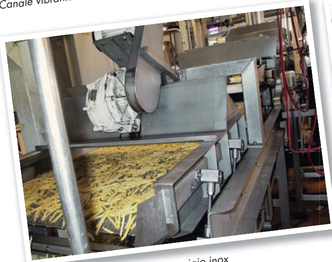
Canale vibrante con bracci in acciaio inox
