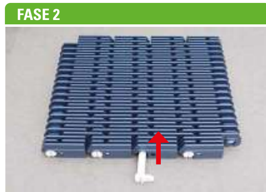
2 - Inserire il pin-clip all'interno della cerniera. Spingere fino alla posizione finale seguendo la direzione della freccia rossa.
