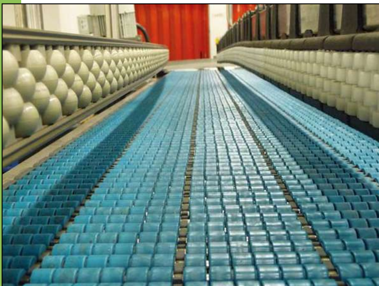
SISTEMA DI ACCUMULO PER PRODOTTI IMBALLATI CON INVOLUCRO TERMORETRAIBILE.
