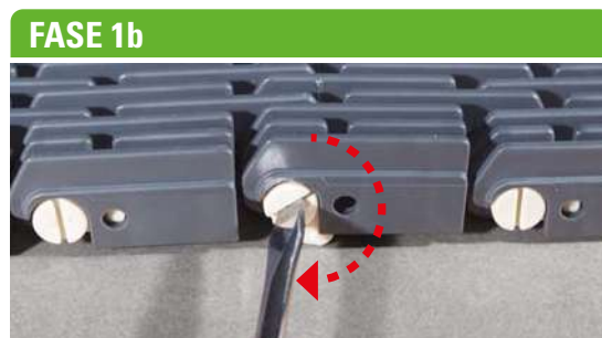
1b - Perno-clip ruotato di 90°.
