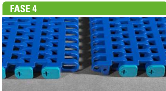
2 - La clip viene spinta fuori grazie alla rotazione del cacciavite.
