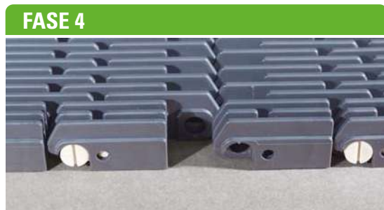
2 - La perno-clip viene spinta fuori dalla rotazione del cacciavite. Ripetere le stesse operazioni (fasi 1A-1B-2) per il lato opposto.
